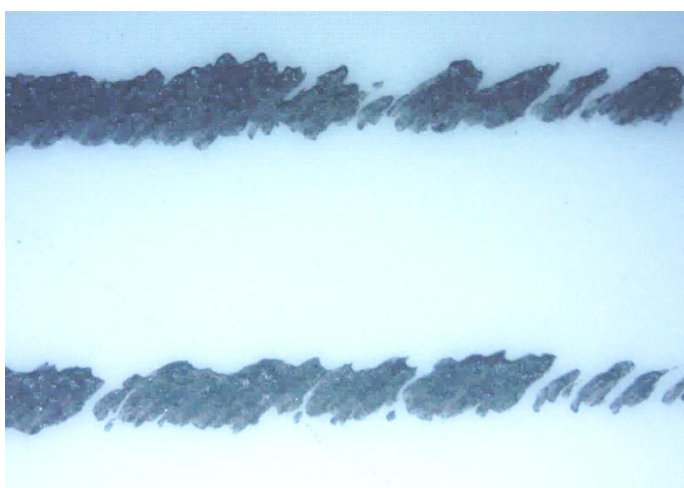
Obr. 20: Vliv odtrhu na strukturu vrstvy
