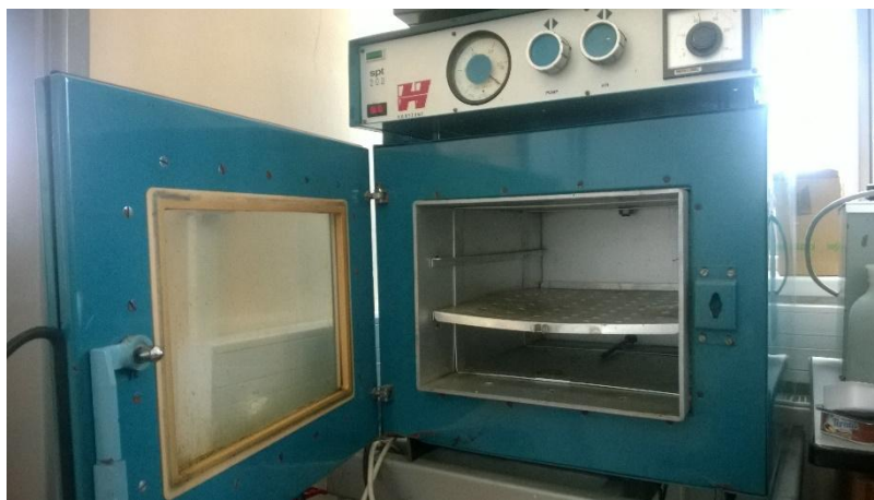
Obr. 14: Použitá pec s odporovým ohřevem
