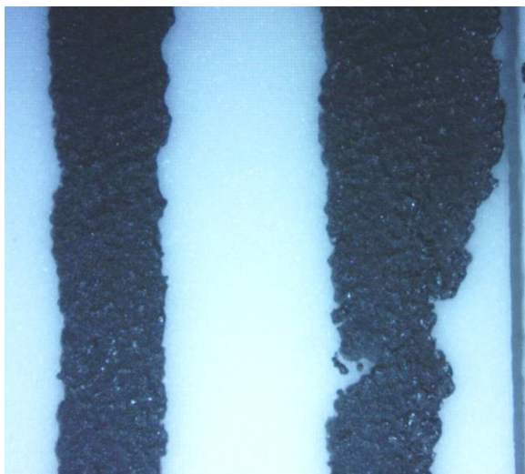
Obr. 21: Pasta rozlitá mimo požadovaný vzor
